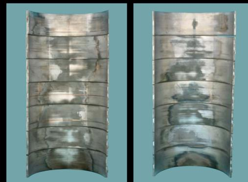
Ces photos comparatives du palier principal inférieur montrent qu'après 370 000 km de service intense et sous charge élevée, la résistance à l'usure de l'huile moteur Mobil Delvac 1 ESP 0W-40 (à droite) était égale ou supérieure à l'huile moteur 15W-40 la plus populaire (à gauche).
